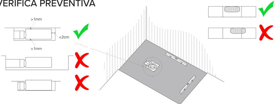
Preparare, con l'ausilio di materiali rigidi (es. cemento, piastrelle, mattoni, ecc) **una base solida** e stabile non deformabile e totalmente livellata.
