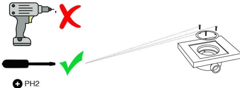
Prima di procedere con la stesura del mastice di poliuretano per il fissaggio del piatto doccia, collocarlo sulla base e collegarlo alla piletta di scarico utilizzando un cacciavite **evitando l'utilizzo di qualsiasi avvitatore elettrico!** Versare acqua e verificare che defluisca in maniera corretta e veloce.
